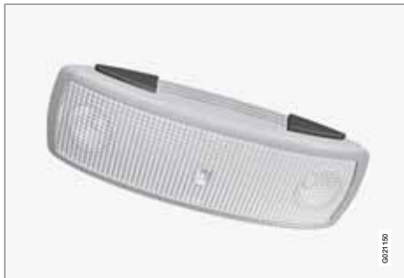
Потолочное освещение сзади.
