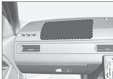
Расположение подушки безопасности на стороне пассажира в автомобиле с правосторонним управлением
