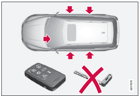
Точки запертия дистанционным ключом без плоского ключа, когда скрытое запертие активировано.
