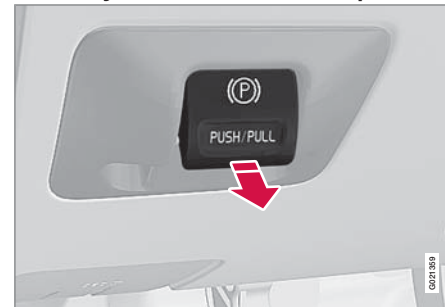
Ручка управления стояночным тормозом.
