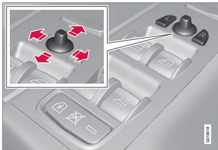
Управление внешними зеркалами заднего вида.
