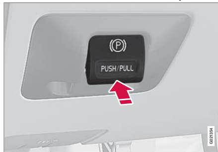
Ручка управления стояночным тормозом.
