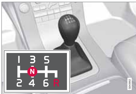
Схема переключения передач, 6-ступенчатая коробка передач
