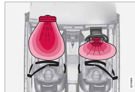
Система подушек безопасности, автомобиль с правосторонним управлением.
