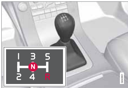
Схема переключения передач, 5-ступенчатая коробка передач
