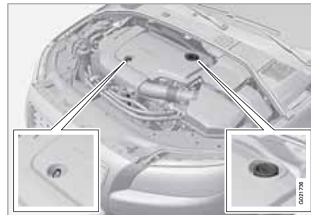
Масломерный щуп 1 и маслозаправочная горловина, дизельный двигатель.
