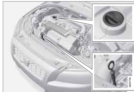
Масломерный щуп 1 и маслозаправочная горловина, бензиновый двигатель.
