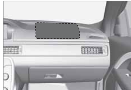
Расположение подушки безопасности на стороне пассажира в автомобиле с левосторонним управлением.
