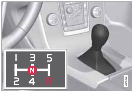
Схема переключения передач, 5-ступенчатая коробка передач.
