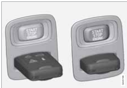
Замок запуска с выдвинутым/вставленным ключом зажигания.
