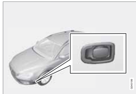
Гнездо для подключения подогревателя двигателя.
