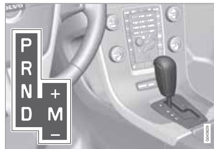
D: Положения в автоматическом режиме. M (+/-): Положения в ручном режиме.
