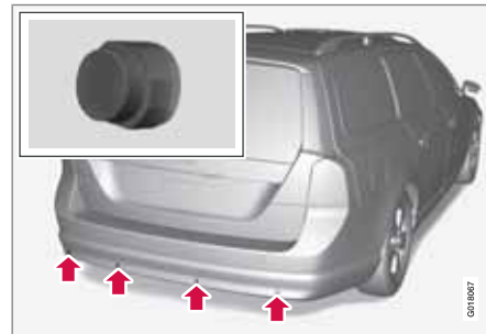
Расположение задних датчиков.
