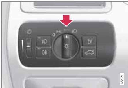
Ручка регулировки света в положении AUTO .
