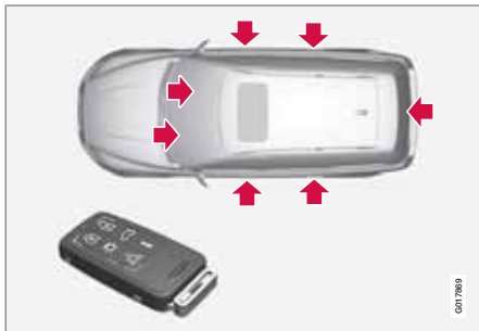
Точки запирания дистанционным ключом с плоским ключом.
