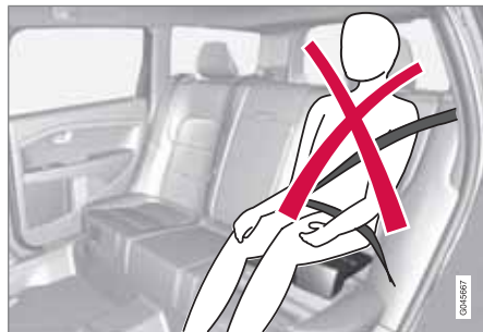
Неправильное положение, голова не должна находиться выше подголовника, и ремень не должен лежать ниже плеча.
