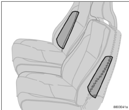
Расположение боковых подушек безопасности.
