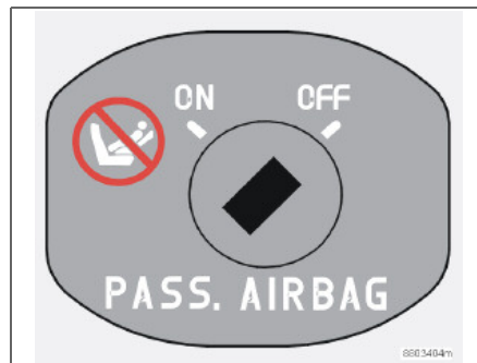
Переключатель SRS в положении OFF (Выкл).
