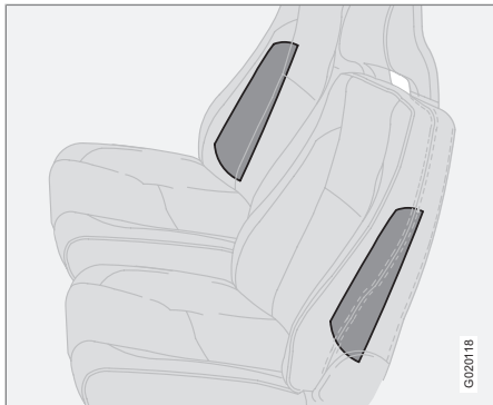
Расположение боковых подушек безопасности.
