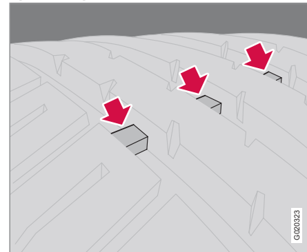
Индикатор износа шин.
