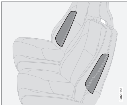
Расположение боковых подушек безопасности.
