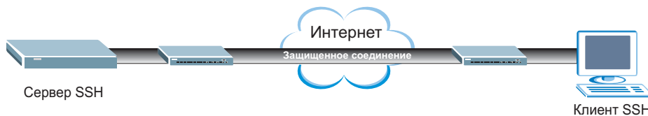
Рисунок 178 Пример связи по протоколу SSH
