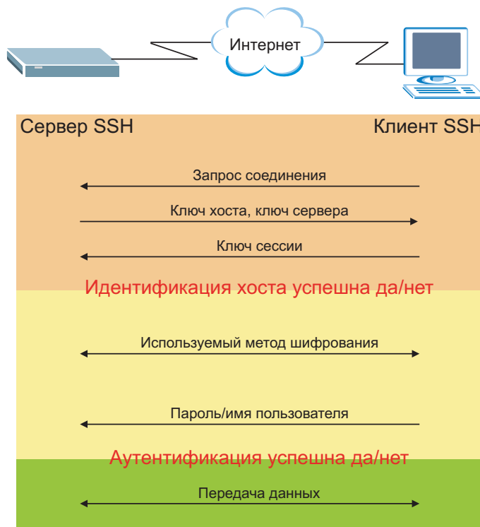
Рисунок 179 Как работает протокол SSH
