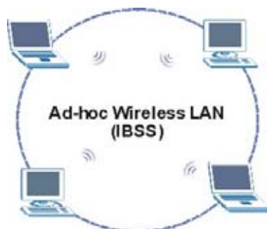
Схема 44-1 Соединение равноправных узлов в независимую сеть
