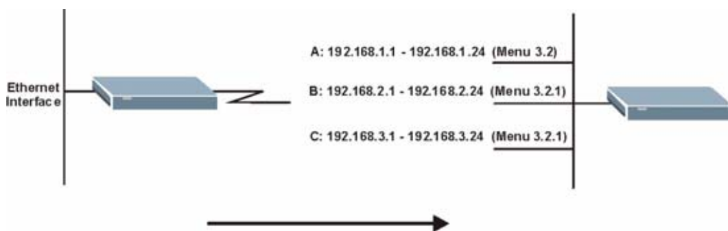
Рис. 68 Пример сети с использованием псевдонимов IP
